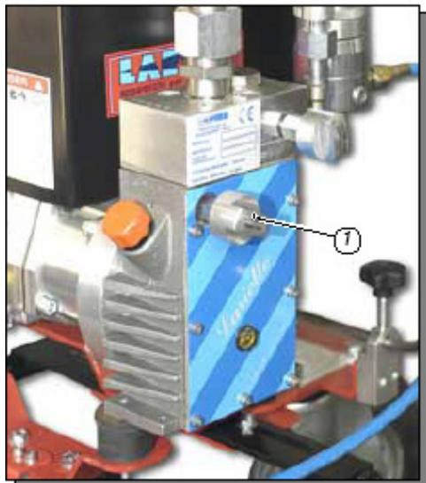
1. Установите давление на минимум поворотом ручки –регулятора (1) против часовой стрелки до упора.
